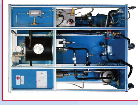
AEHC Equipo de Hidrogenación , Controlado desde Computador (PC)
