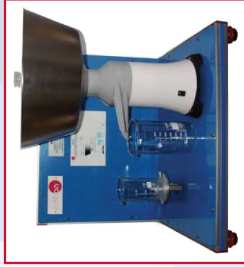
EMANC Equipo Didáctico para Fabricación de Mantequilla , Controlado desde Computador (PC)
