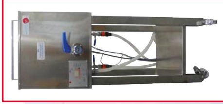
EMANC Equipo Didáctico para Fabricación de Mantequilla , Controlado desde Computador (PC)
